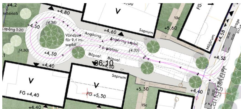
Figur 15. Central kvartersgata med simulerad sopbils körspår
