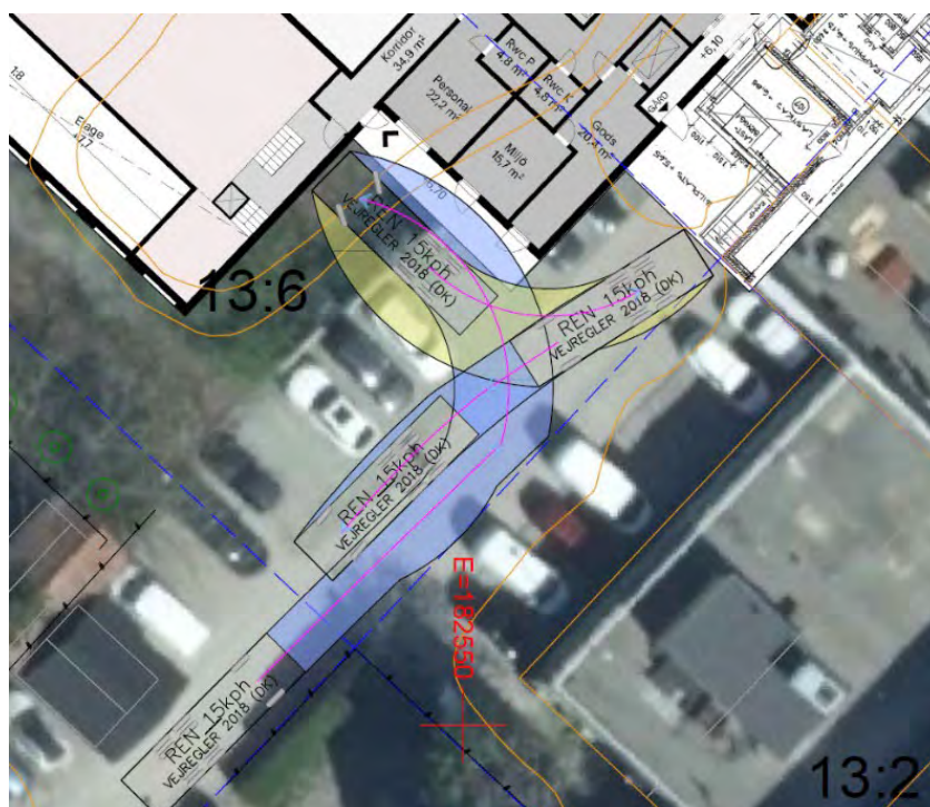
Figuren visar simulerat körspår för sopbilars angöring till hotellet. Observera att parkeringsplatserna inom körspåret kommer att försvinna.
