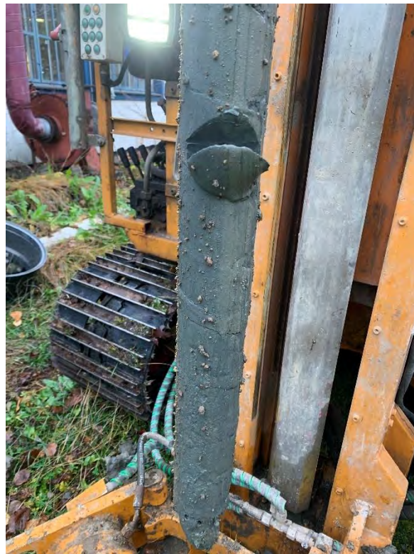
Figur 7.4 Förekommande grå, tätare lera. Bilden visar borkärnan från provpunkt SM1 på ett djup av 2 – 3 m.
